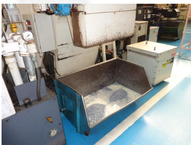
Cavacos misturados ao óleo solúvel
