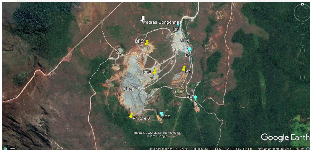
Imagem 2. Vista da mina com estruturas: Cava, UTM, Pilhas 1,2 e 3, Pilha 4. Bacia Norte (BN), Bacia Sul (BS), Bacia Existente (BE), Dique de Contenção de Sedimentos (DCS), Bota Fora (BF) 5 e BF 6. Fonte: Google Earth em 25/06/2020.
