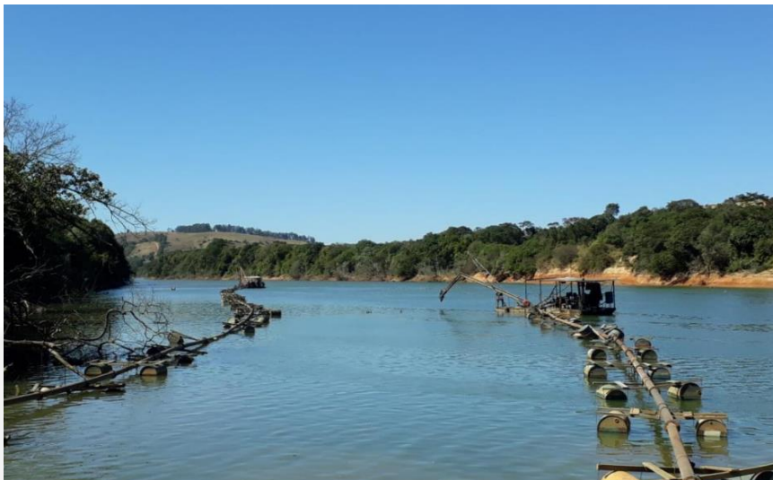
Figura 04: Dragas utilizada no processo de extração de areia no leito do Rio Grande nos limites dos direitos minerários. Fonte: PCA.
