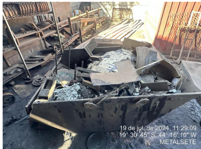
Foto 56: Caçamba ao lado da oficina, com resíduos contaminados misturados às sucatas metálicas;
