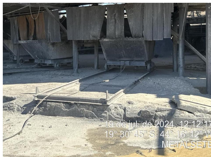
Foto 10: Rodeio lubrificado, para receber o gusa líquido;
