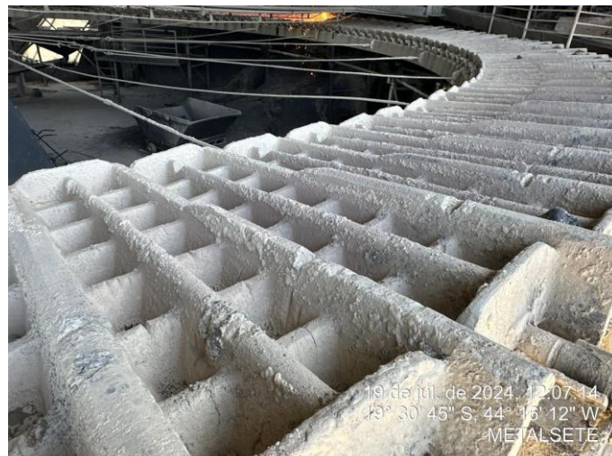
Foto 10: Rodeio lubrificado, para receber o gusa líquido;
