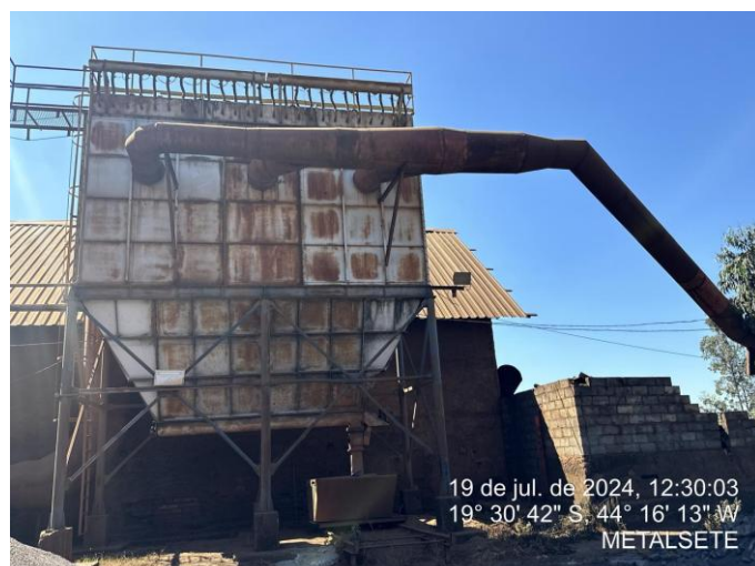
Foto 22: Filtro de mangas no peneiramento do minério;
