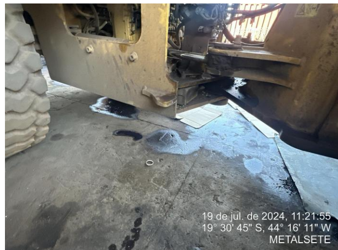
Foto 54: Máquina em manutenção, com vazamento de óleo sem contenção adequada;
