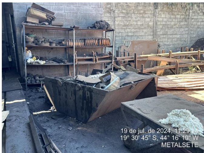
Foto 55: Caçamba ao lado da oficina, em local descoberto, direto ao solo com acúmulo de outros resíduos;
