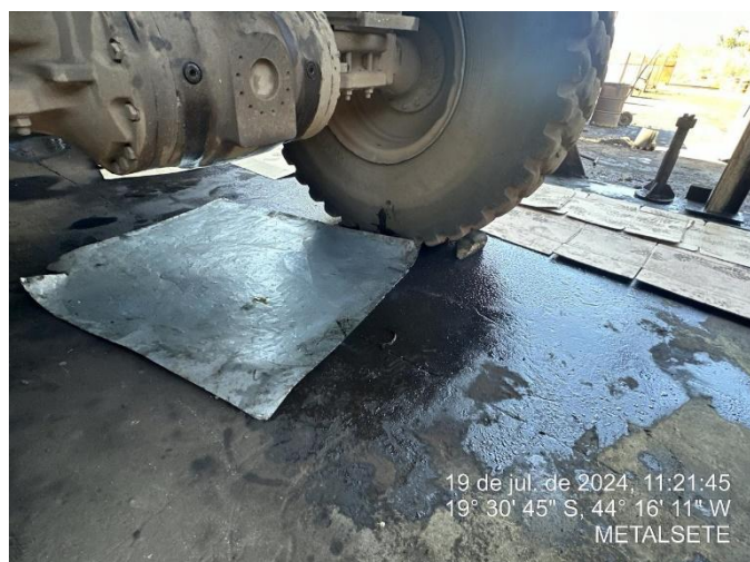
Foto 53: Máquina em manutenção, sem contenção do vazamento;
