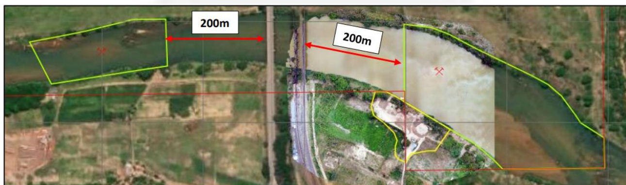
Figura 3: Planta de Detalhe Ortofoto da Stinguel Com. de Areia e Serviços Ltda., com destaque para o distanciamento das poligonais (em verde) das novas áreas de extração de areia em relação as pontes existentes no local.
