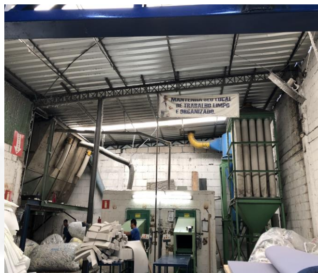
Foto 06. Área de produção de flocos de espuma e à direita da imagem o sistema de filtro manga.
