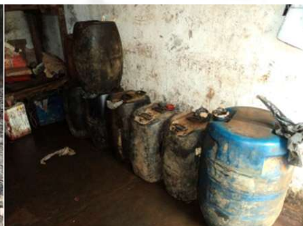
28. Óleo lubrificante usado armazenado em galpão sem contenção para vazamentos – RIMA, pg 66.
