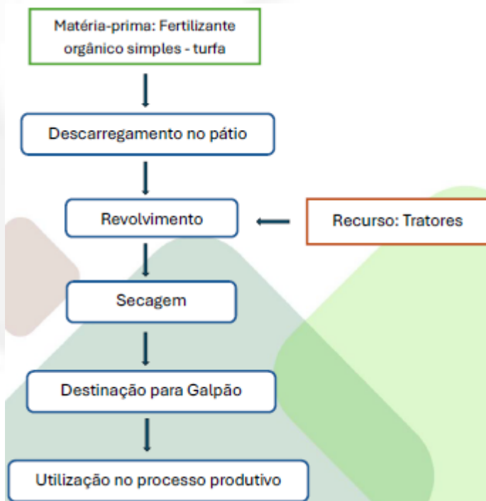
FIGURA 10 - Fluxograma da secagem de turfa - pátio 02. Fonte: Resposta à solicitação de informações complementares
