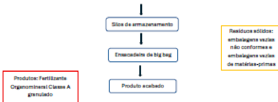
FIGURA 05 - Fluxograma da formulação de fertilizantes granulados. Fonte: Resposta à solicitação de informações complementares
