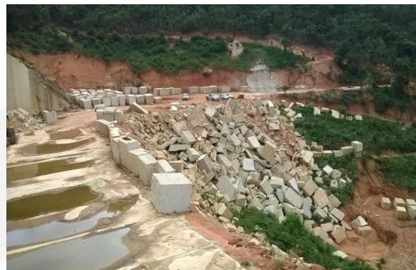
Foto 2. Pilha de rejeito/estéril e frente de lavra
