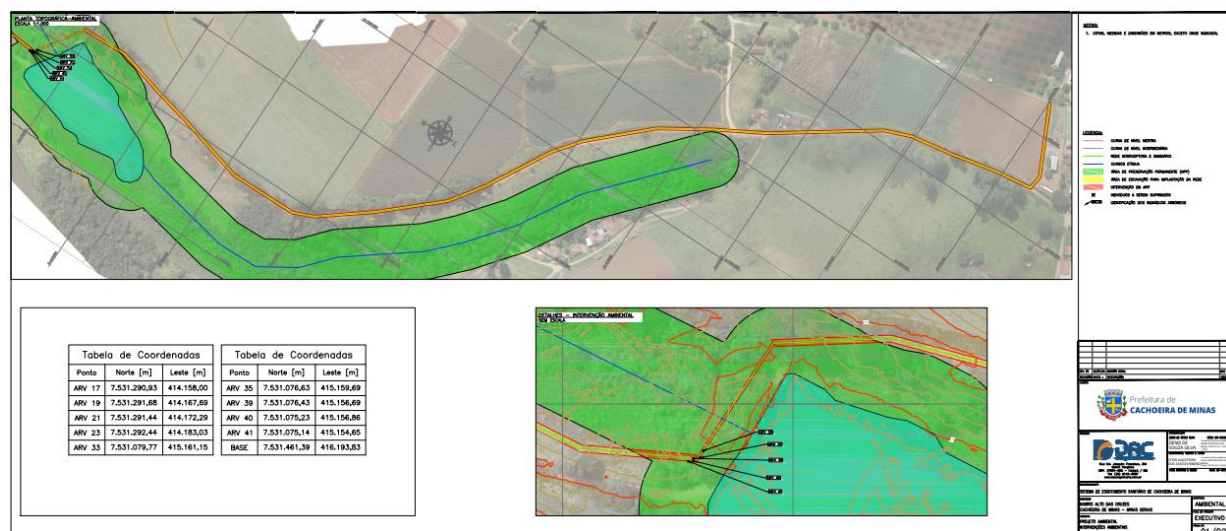
Figura 4: Planta Topográfica 2 da área da ETE e da rede interceptora e de emissário.
