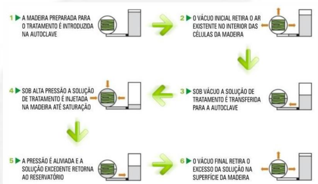
Figura 02: Fluxograma do processo produtivo do empreendimento Tratasete Madeiras Tratadas e Imunizadas EIRELI. Fonte: RCA, 2021
