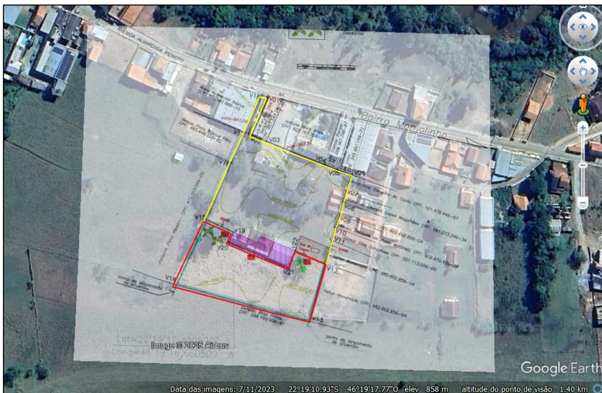
Figura 1 – Imagem aérea com sobreposição da planta planialtimétrica, onde nota-se a delimitação do imóvel (em amarelo), do aterro de RCCs e da área de triagem (em vermelho), do galpão de maquinário (em magenta), do sistema de drenagem de águas pluviais (em azul) e dos indivíduos arbóreos isolados (em verde). Fonte: Arquivos .shp e planta planialtimétrica encaminhados pelo empreendedor inseridos no software Google Earth. Data da imagem: 11/07/2023.
