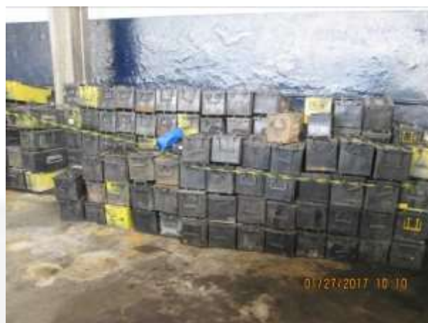
Foto 6 – baterias sendo armazenadas em local inadequado.
