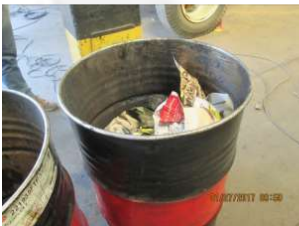
Foto 3 – não existe uma separação de resíduos dentro da empresa sendo o Classe I misturado com o Classe II.
