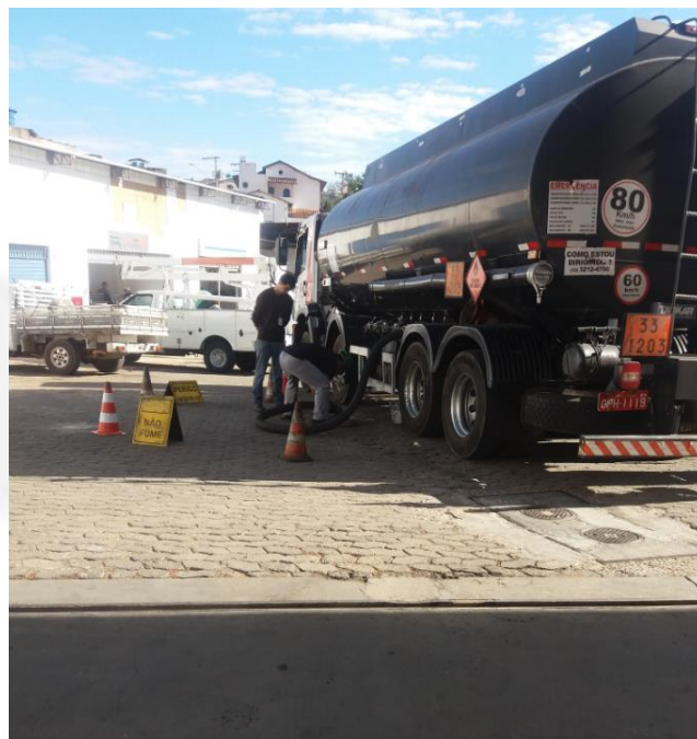
Foto 02: Descarga selada sendo realizada nos tanques subterrâneos.
