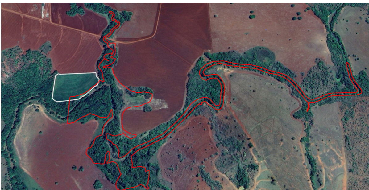
Imagem 3 - Área de empréstimo de solo para construção do talude do barramento para irrigação (polígono branco). Fonte: Google Earth (2025)
