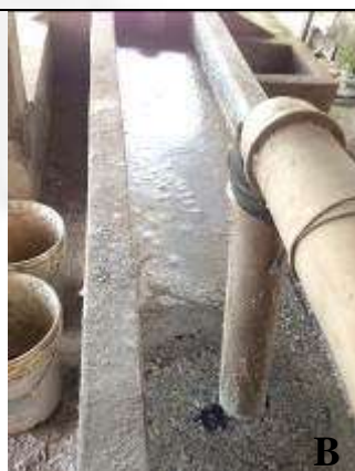
Foto 15. Alguns resíduos sólidos – A: resíduo sólido da secadora centrífuga constituído de plástico moído; B: primeira etapa do sistema de tratamento (canal de alvenaria), aonde chega plástico moído; C: resíduo retido na peneira (identificada como gradeamento) referente ao material coletado no canal da foto B e D: resíduo recolhido no funil (embalagem do tipo Big Bag) da peneira estática.
