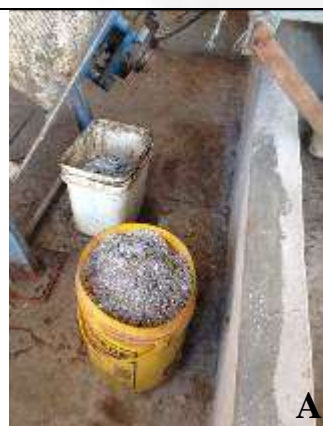
Foto 15. Alguns resíduos sólidos – A: resíduo sólido da secadora centrífuga constituído de plástico moído; B: primeira etapa do sistema de tratamento (canal de alvenaria), aonde chega plástico moído; C: resíduo retido na peneira (identificada como gradeamento) referente ao material coletado no canal da foto B e D: resíduo recolhido no funil (embalagem do tipo Big Bag) da peneira estática.
