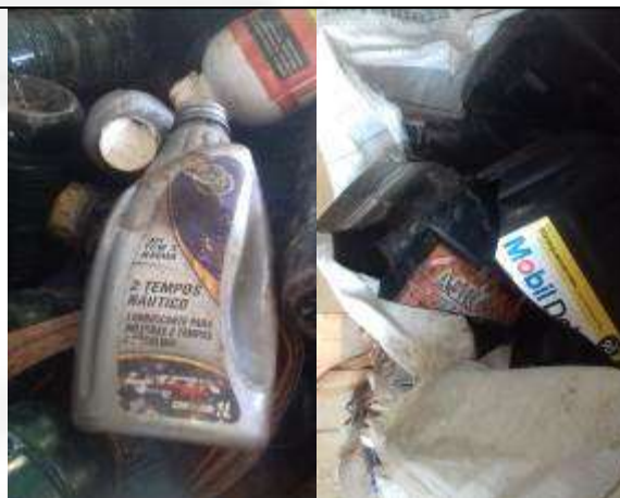
Foto 02. Embalagens de óleo lubrificante armazenadas em embalagem do tipo Big Bag no galpão de produção. Embalagens pretas grandes cortadas ao meio e separadas por cor, prontas para o encaminhamento para o processo produtivo.
