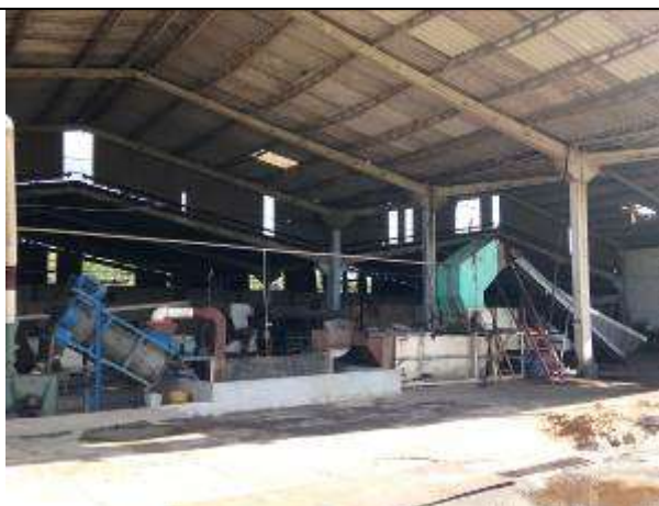
Foto 05. Vista parcial do galpão de produção, onde aparecem os equipamentos referentes ao processo produtivo: esteira, moedor, tanque metálico, lavadora centrífuga e secadora centrífuga.
