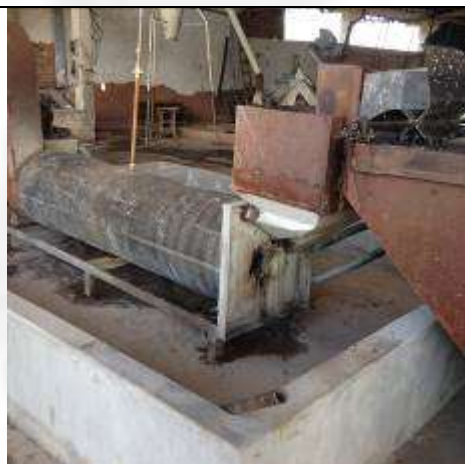
Foto 07. Vista da lavadora centrífuga instalada dentro de uma bacia de contenção.
