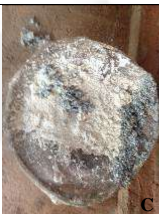
Foto 15. Alguns resíduos sólidos – A: resíduo sólido da secadora centrífuga constituído de plástico moído; B: primeira etapa do sistema de tratamento (canal de alvenaria), aonde chega plástico moído; C: resíduo retido na peneira (identificada como gradeamento) referente ao material coletado no canal da foto B e D: resíduo recolhido no funil (embalagem do tipo Big Bag) da peneira estática.
