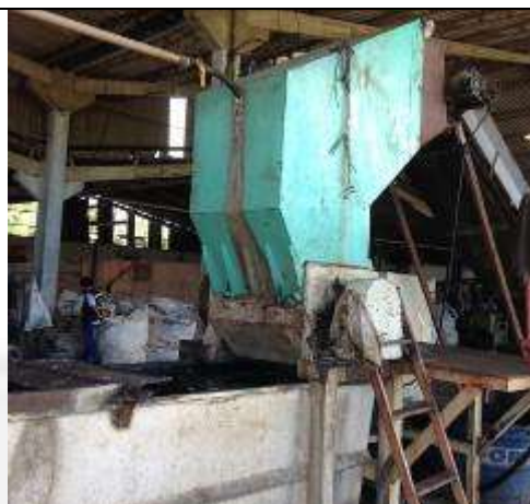
Foto 06. Vista parcial do moedor conectado a uma esteira e do tanque metálico. Vista de tubulação que chega ao moedor, sendo informado que a mesma será da reutilização da água.
