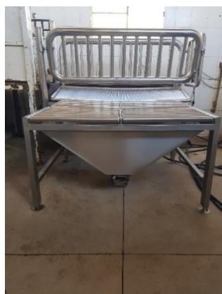
Figura 1: Mesa de abate - Bacia Inox para recolhimento de sangue
