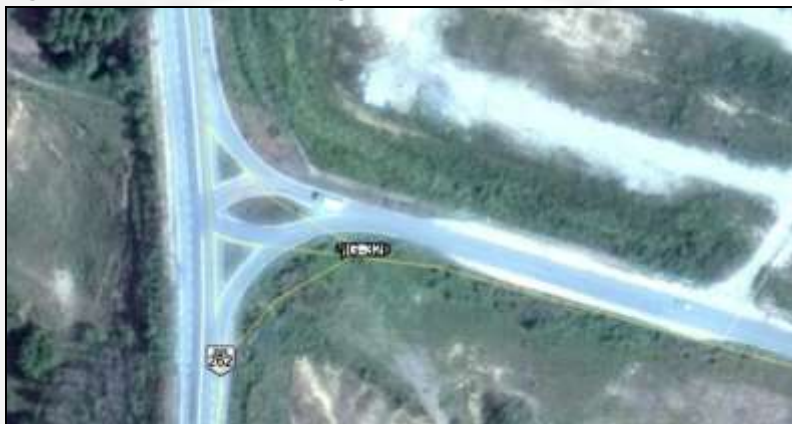
Imagem 2: Interseção do tipo "gota canalizada", entre a BR 262 e MG 320.
