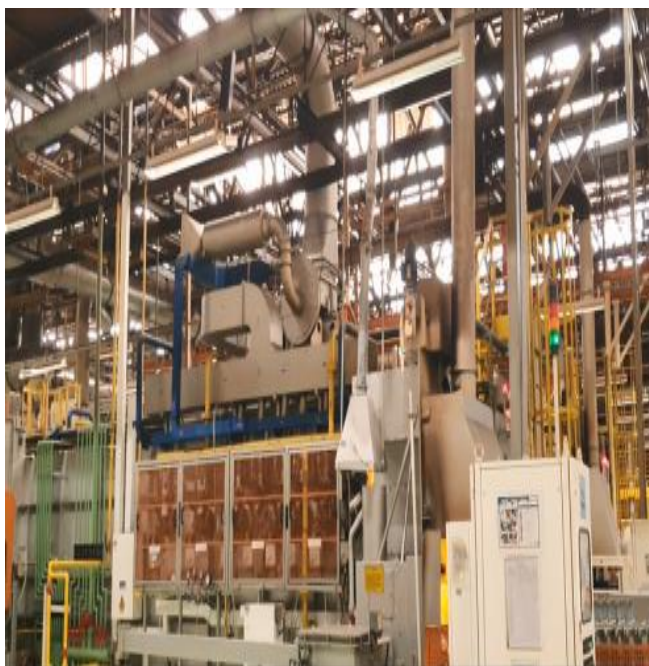
Foto 05. Fornos Tratamento Térmico e Sistema de Exaustão
