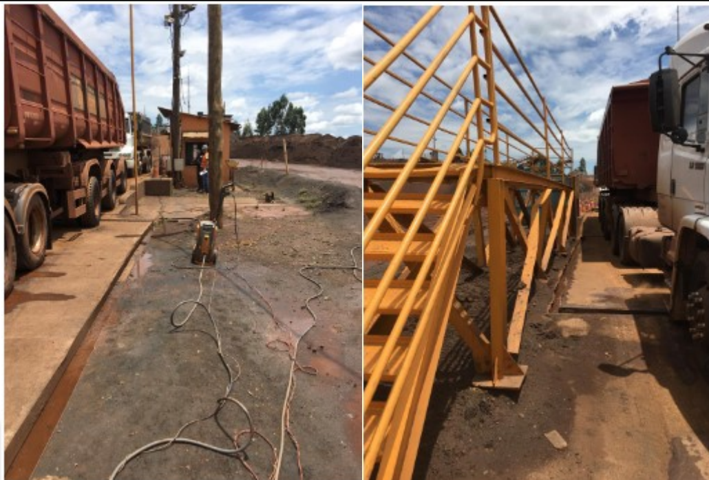
Figura 2.2.1.4.2. Lavador de rodas (esquerda) e ponto de enlonamento (direita).
