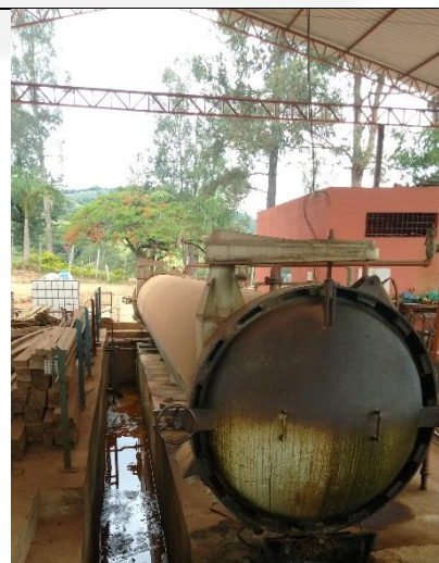
Figura 3. Uma das autoclaves, com bacia de contenção e sob área coberta.
