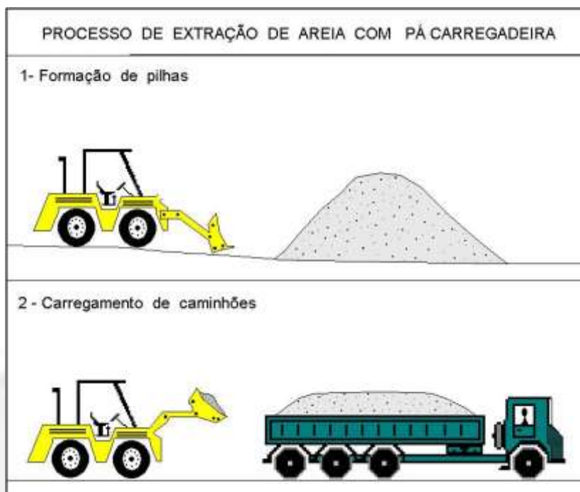
Figura 03: Processo de extração de areia com pá carregadeira.
