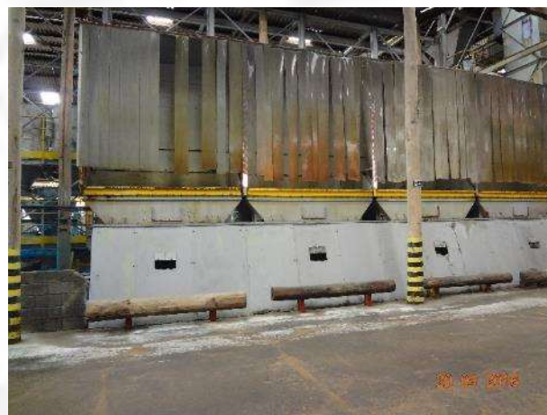
Fig.3 – Sistema de enclausuramento no setor de descarga e nas correias transportadoras.
