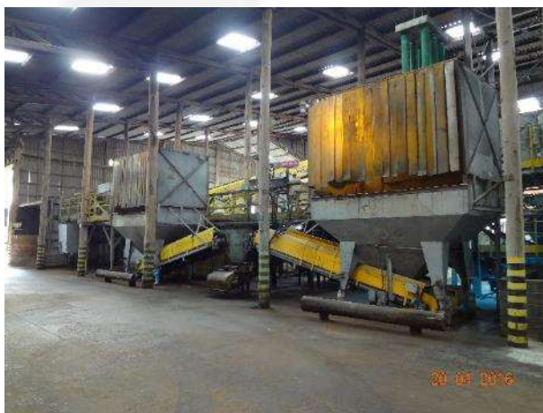
Fig.3 – Sistema de enclausuramento no setor de descarga e nas correias transportadoras.
