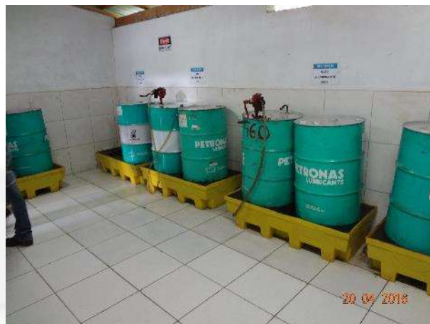
Fig.6 – Local para manutenção das pás carregadeiras, coberto e com piso impermeável, além de canaletas de condução, o depósito de óleo em local totalmente enclausurado e acesso restrito.
