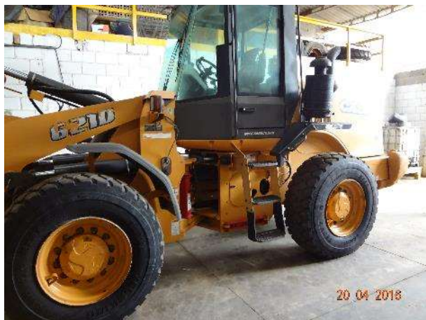
Fig.6 – Local para manutenção das pás carregadeiras, coberto e com piso impermeável, além de canaletas de condução, o depósito de óleo em local totalmente enclausurado e acesso restrito.
