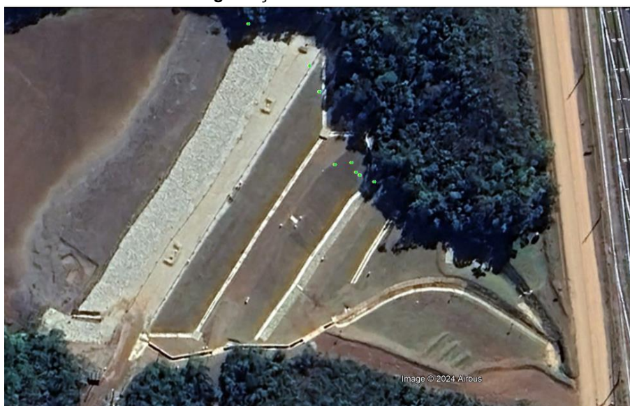
Figura 1. Imagem da Barragem Didão, já demonstrando as alterações realizadas para contemplando as obras de melhorias e incremento do fator de segurança.
