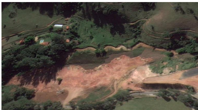
Desvio do Córrego Santa Luísa para um canal escavado e intervenção em APP decorrente da disposição de estéril no ano de 2014.
