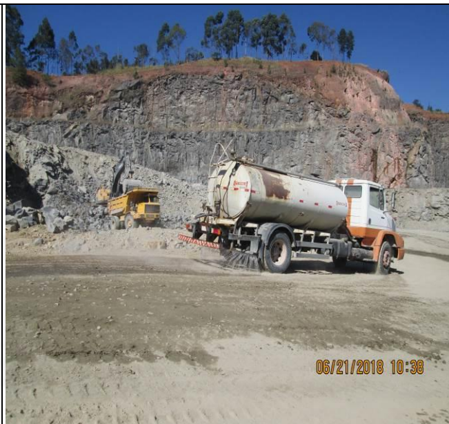
Foto 2: Vista da frente de lavra em operação com caminhão-pipa aspergindo as vias de acesso
