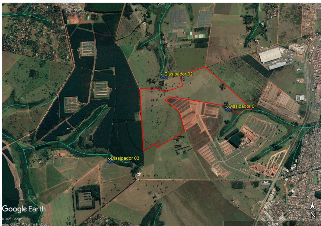
Figura 03: Provável localização dos dissipadores de energia conforme Projeto Preliminar de Drenagem Pluvial do Loteamento Mansour IV e V.
