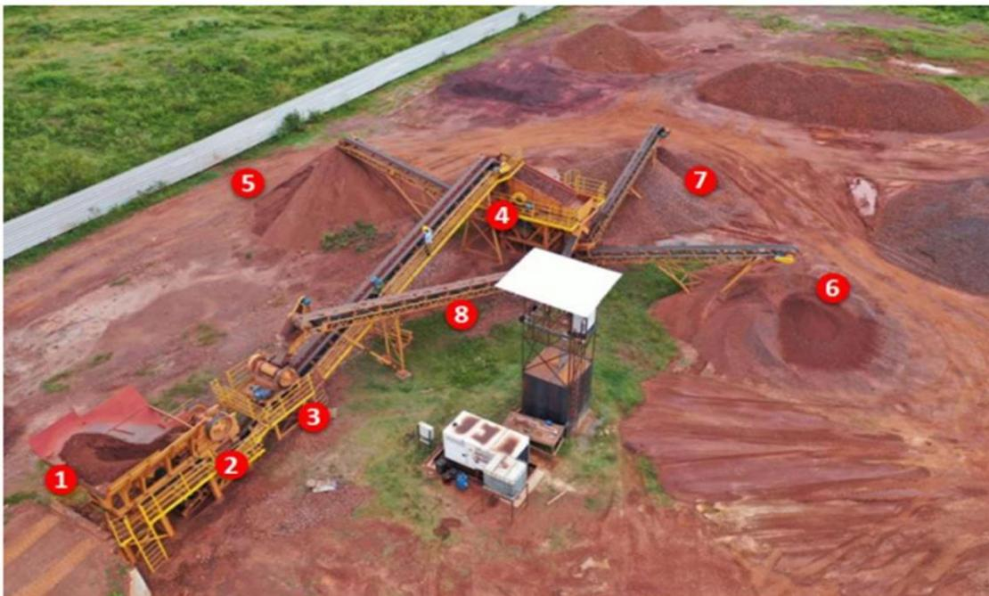
Foto 1. Itens que compõem uma Unidade de Tratamento de Minério (UTM) a seco que poderá ser utilizada no empreendimento.
