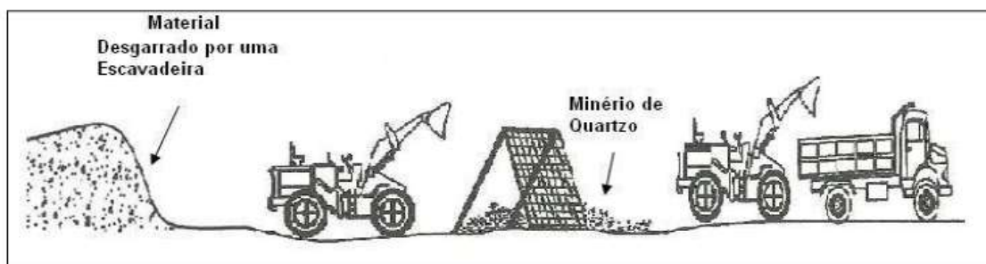
Figura 3 Esquema do processo extração mineral
