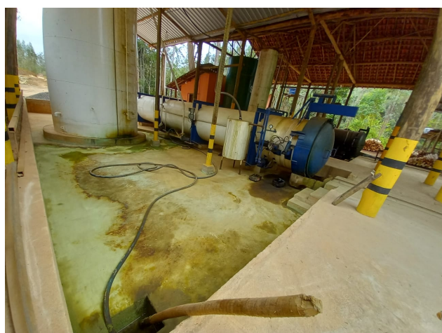
Foto 07: Autoclave instalada sobre fosso de contenção, cuja adequação é Condicionante deste Parecer. Fonte: Vistoria realizada pela Supram-ZM.
