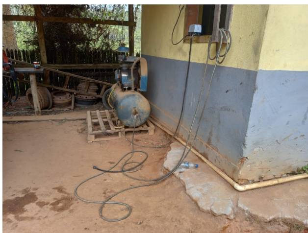
Foto 19: Compressor com disposição inadequada. Fonte: Vistoria realizada pela Supram-ZM.
