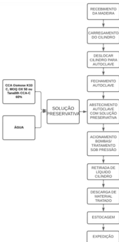
Figura 03: Fluxograma do processo produtivo. Fonte: Estudos Ambientais/RCA.
