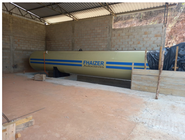
Foto 02: Autoclave e dique de contenção já instalados no galpão de produção.
