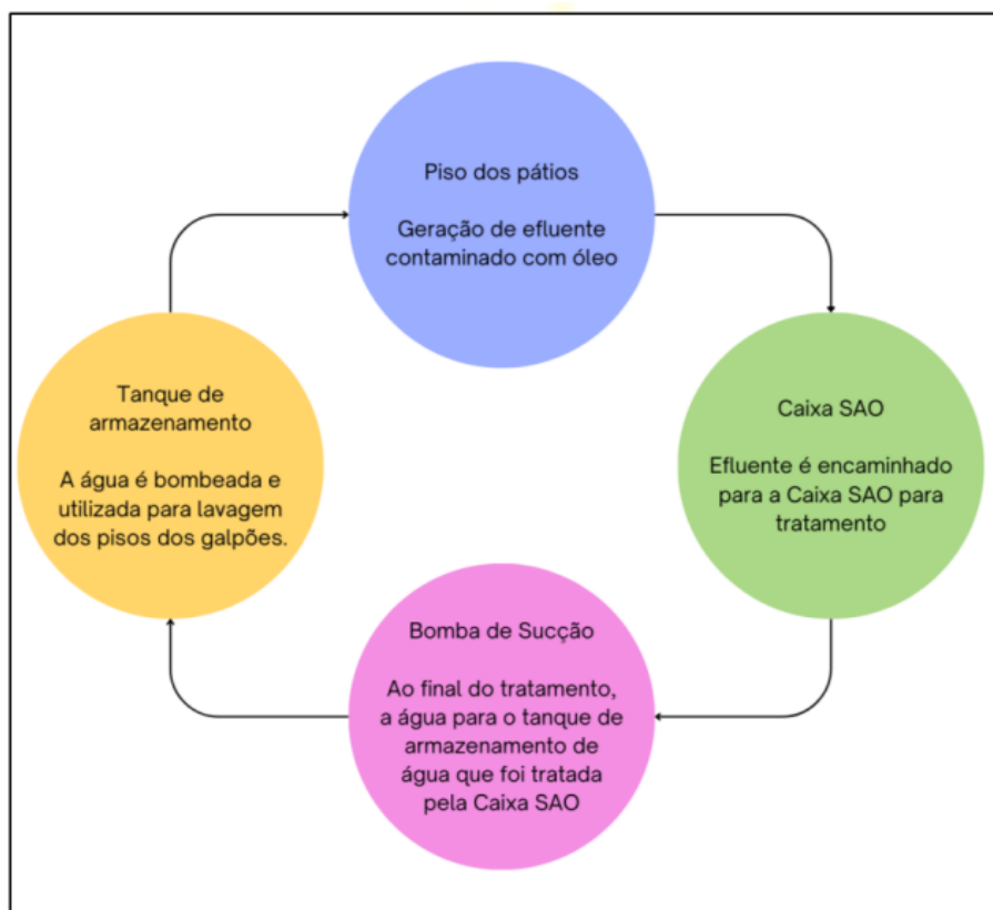
Figura 4 - Fluxograma de recirculação de efluente tratado. Fonte: Informações complementares.
