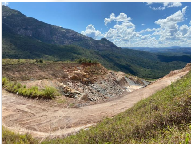
Foto 01 – Vista parcial da frente de lavra de minério de ferro. Observa-se desmoronamento de talude.
