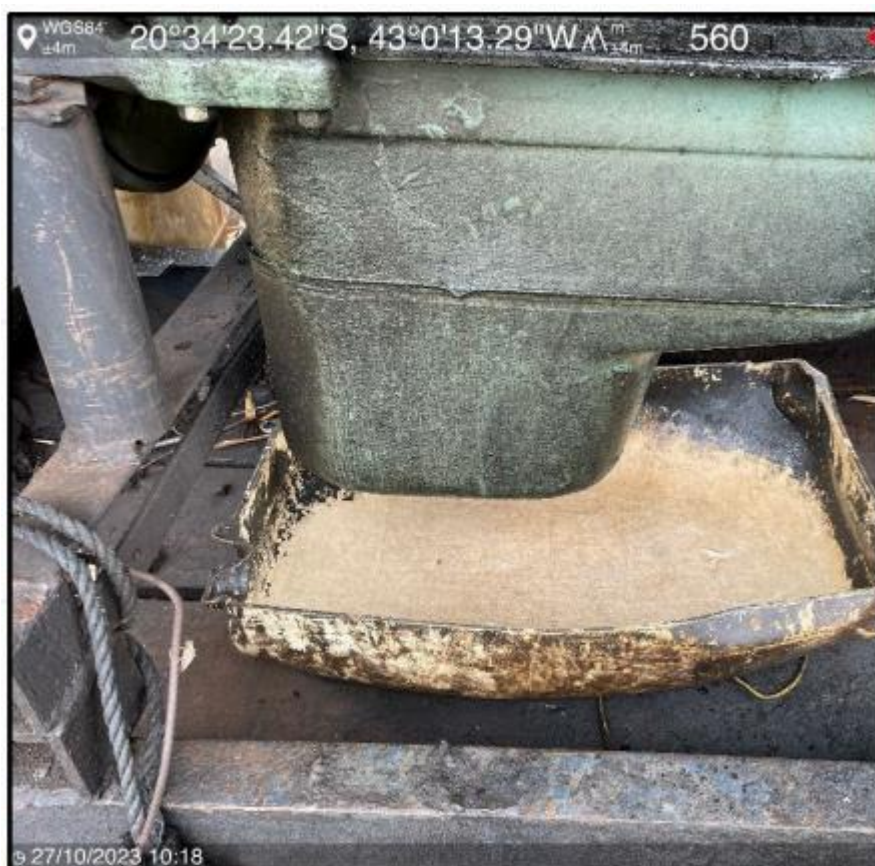
Imagem 4: Recipiente de contenção de possível vazamento de óleo da dragagem, já instalado
