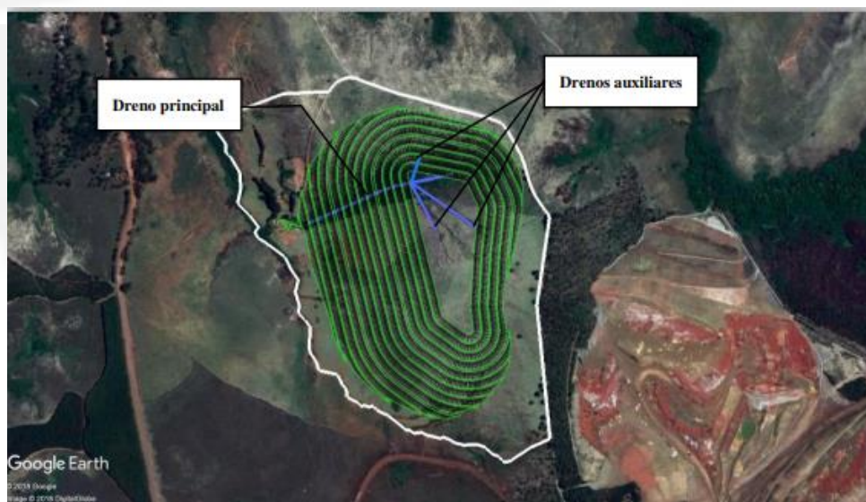
Imagem 02. Projeto sobreposto a imagem de satélite demonstrando os drenos de fundo (principal e auxiliares) e bacia de contenção de sedimentos a jusante da estrutura.
