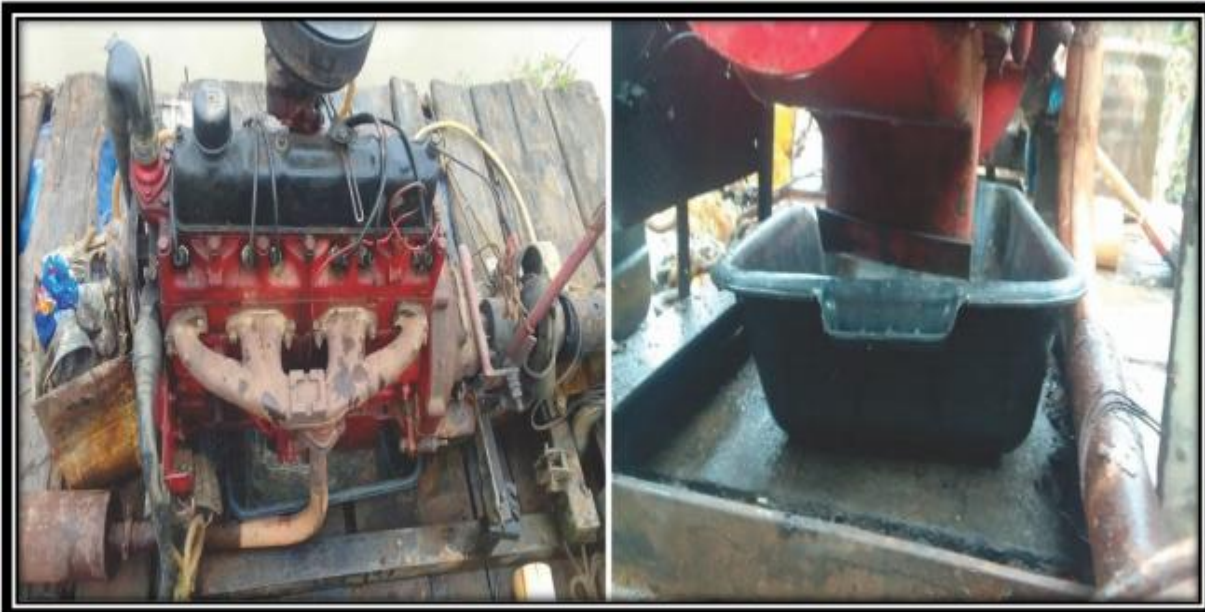
Imagem 2: Imagem da draga, com a bandeja de contenção de vazamento de óleo
