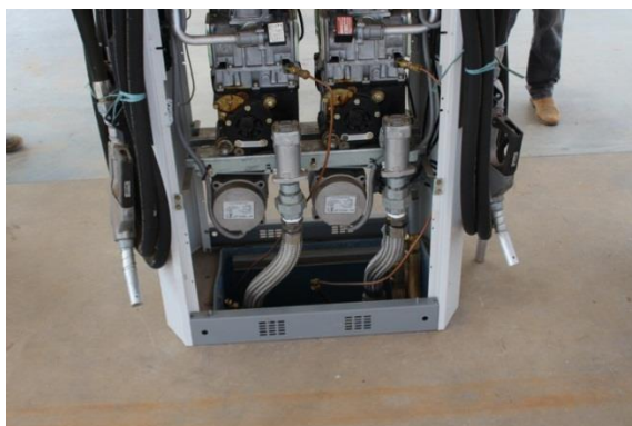
Foto 28 – bombas com sump e check- válvula Foto 29 – bateria de filtros de óleo em uma bacia de contenção dom canaletas ligadas ao SSAO;
