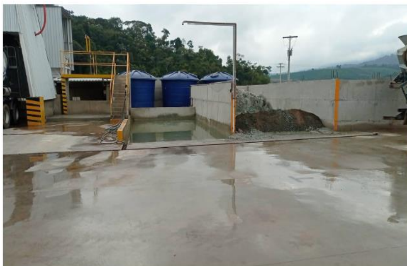
Imagem 3: Vista do redosador (dosagem de água na mistura do concreto); do decantador, que recebe o efluente industrial do empreendimento; caixa seca e caixas d'água para armazenamento de água de reuso.
