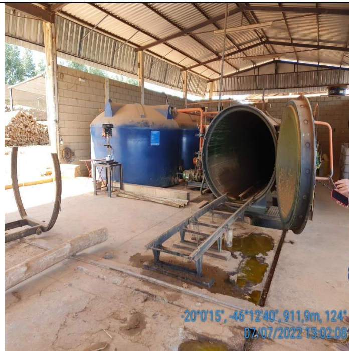
Foto 02. Autoclave com canaletas direcionadas para bacia de contenção
