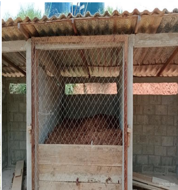
Imagens 07 e 08: composteira com canaleta para contenção de chorume.
