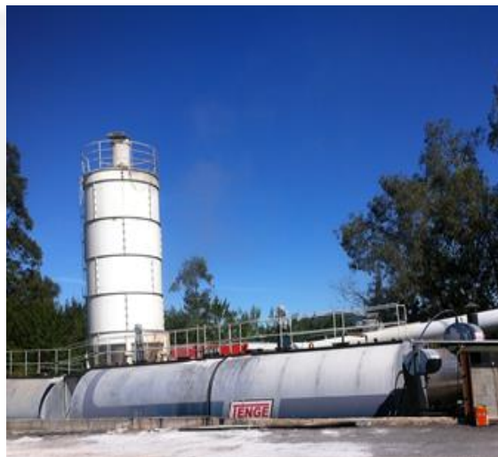
Figura 4 - Aquecimento do CAP
