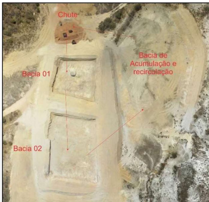
Figura 4: Sistema de circulação hídrica no processo produtivo do empreendimento
