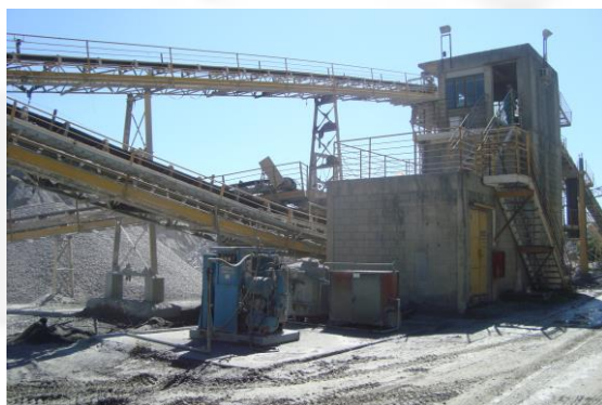
Foto 06. Vista da UTM com sistema controlado de umectação.
