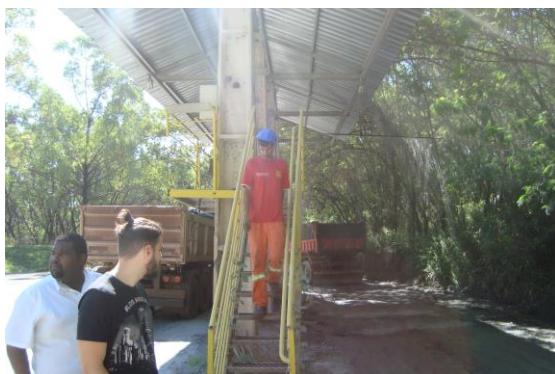
Foto 07. Plataforma de umectação e enlonação das caçambas dos caminhões que utilizam as vias públicas.
