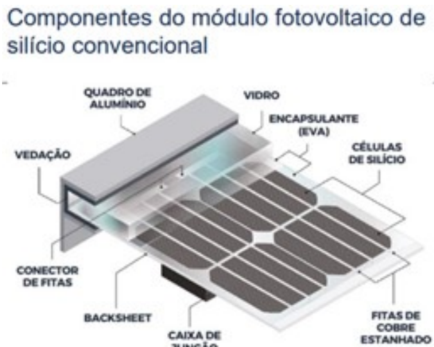
Figura 5 – Componente do módulo fotovoltaico.
