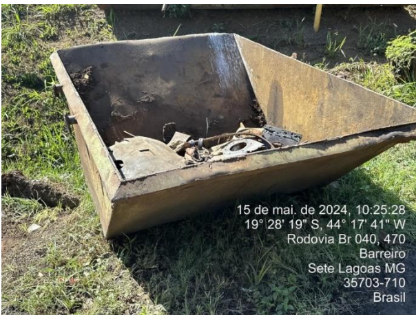
Foto 33: Caçamba contendo mistura de materiais Classe I e II, em área aberta e não pavimentada. O empreendedor foi alertado sobre o risco da percolação de óleo no solo.
