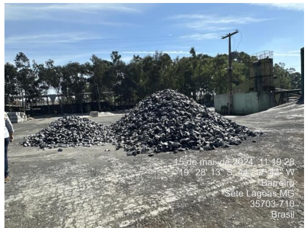
Foto 22: Lingotes despejados diretamente no solo para resfriamento.
