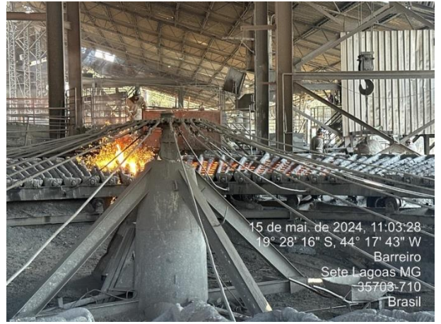
Foto 60: Gusa sendo despejado para fabricação dos lingotes.
