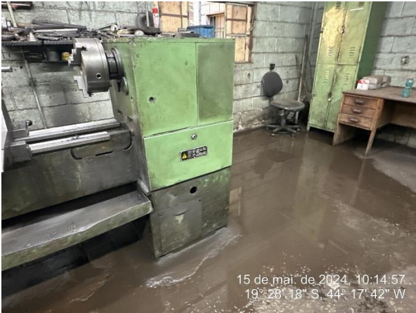
Foto 31: Oficina mecânica, com acúmulo de efluente proveniente de limpeza do local.
