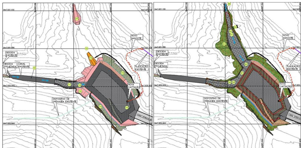
Figura 9: Etapas 7 e 8 do sequenciamento construtivo do sump . Fonte: Walm, 2023.
