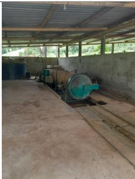
Figura 01: Autoclave utilizada no tratamento da madeira. Aos fundos tanque de armazenamento de solução utilizada no tratamento químico.
