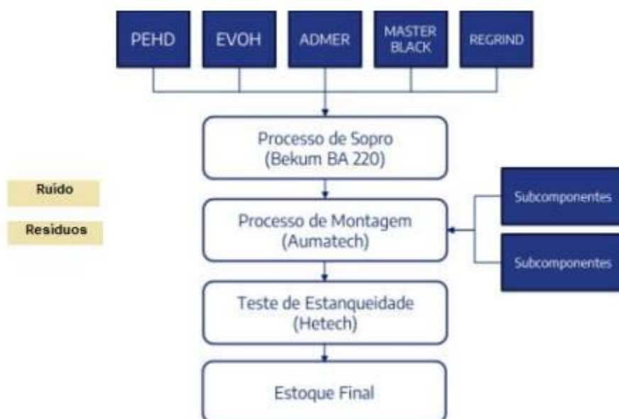
Imagem 02: fluxograma do processo produtivo.
