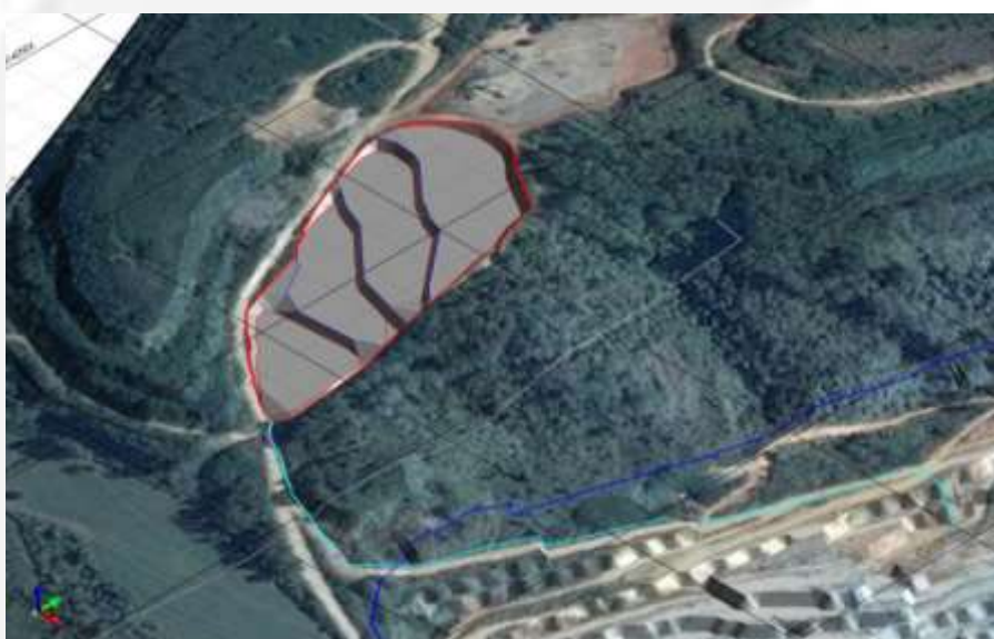
Figura 2.: Conformação da cava prevista para um horizonte de 6 anos.
