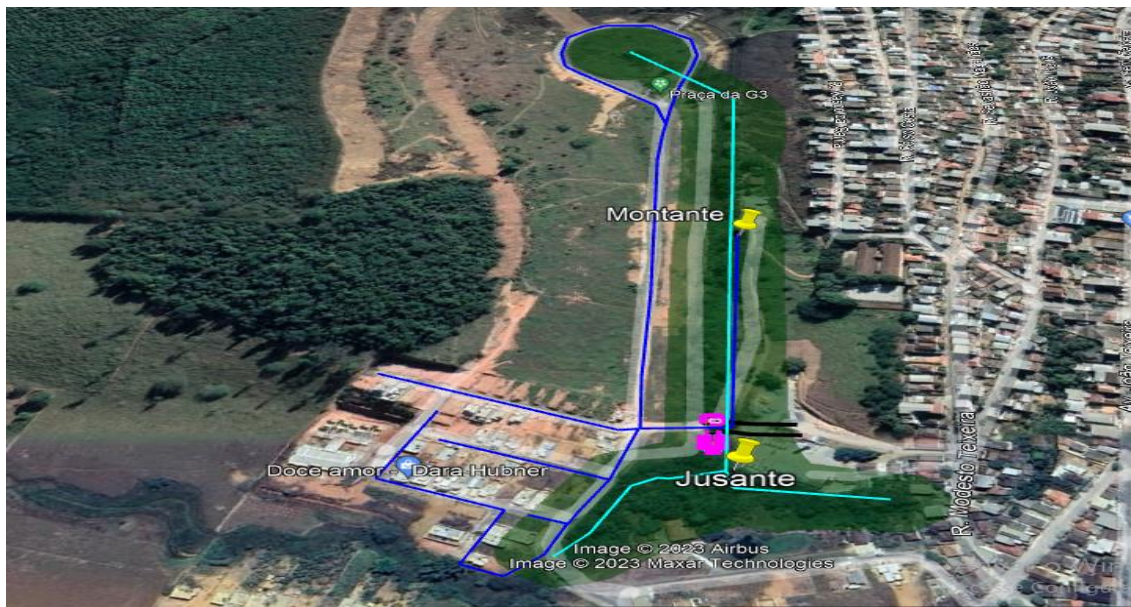
Figura 02. Estruturas da ETE (polígono rosa), curso D' água córrego Chácara (segmento azul) rede coletora (segmento azul) e Pontos de Monitoramento. Fonte: Google Earth, 2023. Elaborado pela URA/LM com base nos arquivos digitais apresentados nos autos.
